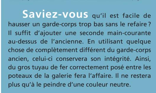
**Saviez-vous** qu'il est facile de hausser un garde-corps trop bas sans le refaire ? Il suffit d'ajouter une seconde main-courante au-dessus de l'ancienne. En utilisant quelque chose de complètement différent du garde-corps ancien, celui-ci conservera son intégrité. Ainsi, du gros tuyau de fer correctement posé entre les poteaux de la galerie fera l'affaire. Il ne restera plus qu'à le peindre d'une couleur neutre.
